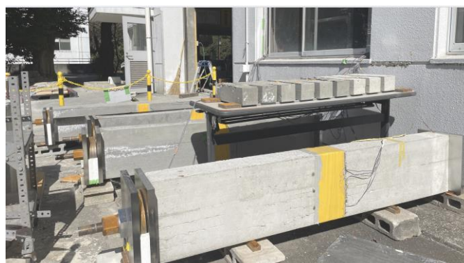
図-2 自己充填ジオポリマー鉄筋コンクリート梁の打設と屋外暴露試験
