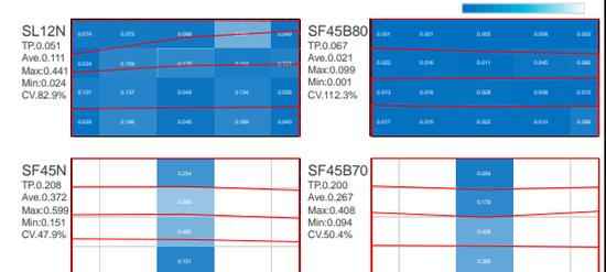
図 4 試験体の表層透気係数
