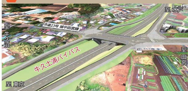
A 【切土区間】（都）城中・田宮線付近
