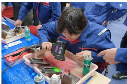
ブラックライトを用いて鋼材の表面欠陥を検出する磁粉探傷試験
