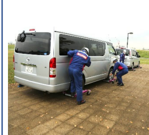
ジャッキをタイヤの下に装着し、車体を持ち上げ
