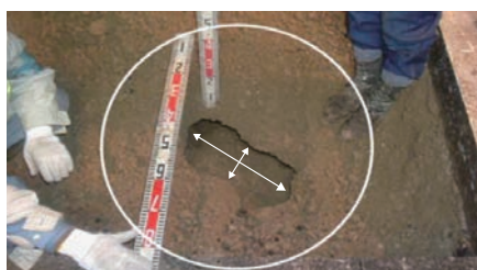
路面下空洞調査により発見された空洞の事例
