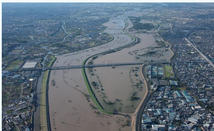
公園などが整備されている荒川第一調節池は、一時的に洪水をためて下流に流れる水の量を減らします。
