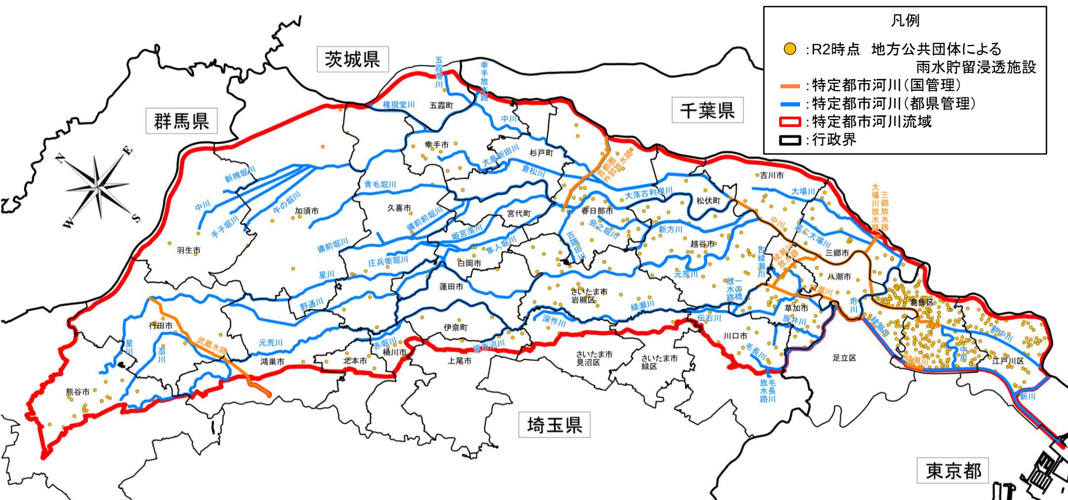
地方公共団体による雨水貯留浸透施設の対策実施箇所(R2末時点)
