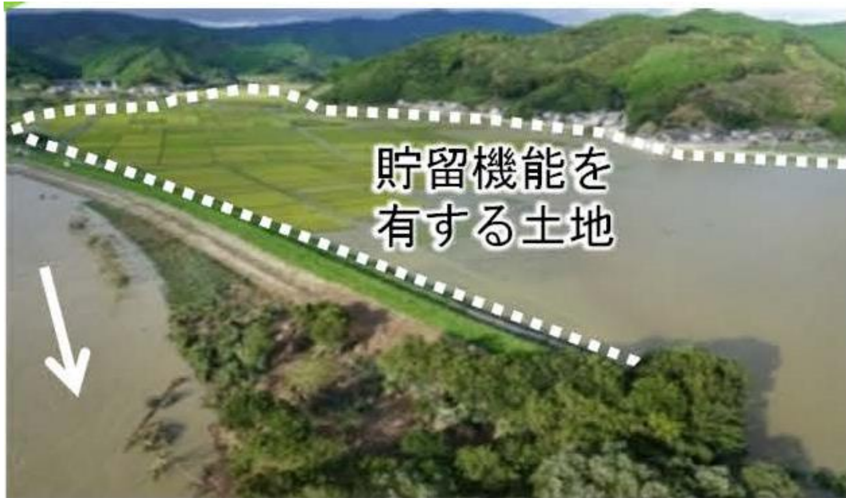
保水・遊水機能を有する土地のイメージ (「解説・特定都市河川浸水被害対策法施行に関するガイドライン」より抜粋)
