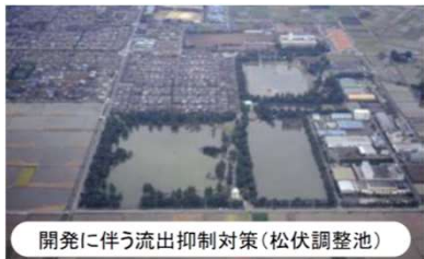
雨水流出抑制対策の例
