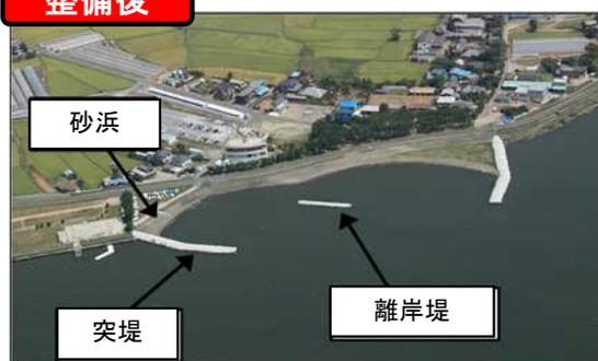
突堤や離岸堤等を整備することで、波の力を弱めると共に、砂の流出を抑制しています。
