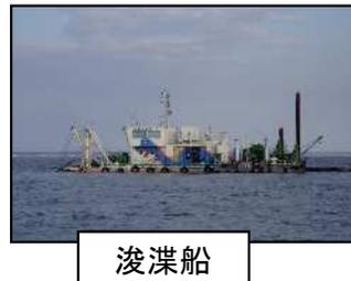
浚渫船を使って底泥を湖外へ取り出し、底泥に含まれる汚濁物質や窒素・リンの溶出を抑制しました。
