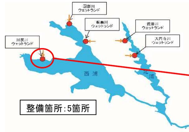
霞ヶ浦の流入河川の河口部に仕切堤で沈殿池を作り、河川から流入する水を一時的に貯め、汚濁物質を沈殿させます。ウェットランドは5箇所整備しました。
