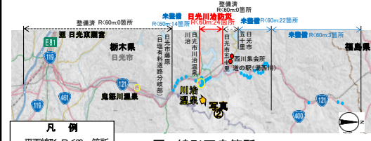
図3 線形不良箇所
