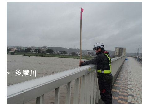
流量観測実施状況(石原地点)
