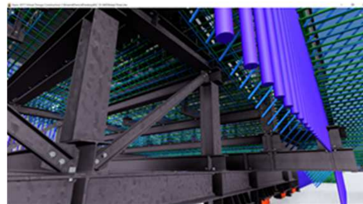
3Dモデルによる架台と鉄筋の干渉確認
