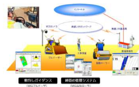
GNSS締固めシステムによる施工状況
