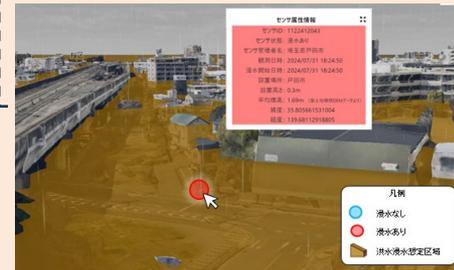
三次元河川管内図に浸水情報をリアルタイム表示 (イメージ)
