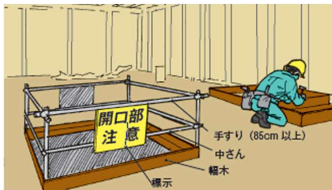
開口部周りの墜落防止措置の例
