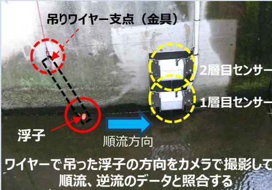
ワイヤーで吊った浮子の方向をカメラで撮影して順流、逆流のデータと照合する
