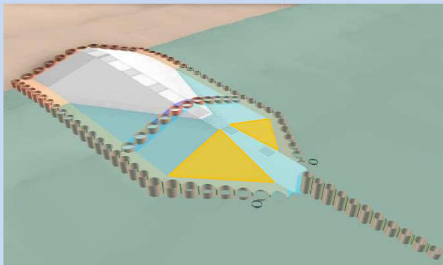
岩盤型潜水突堤 3Dモデル
