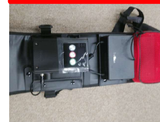
複数SIM(民間回線)を使用した画像伝送システム
