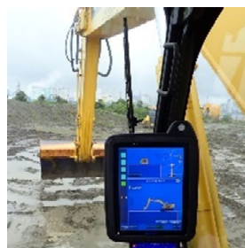
ICT建設機械の施工
