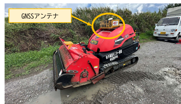
GNSSアンテナの装着状況
