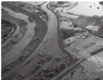
令和元年東日本台風の被害。 越辺川(右下)の右岸堤防が決壊(川越市平塚新田地先)
