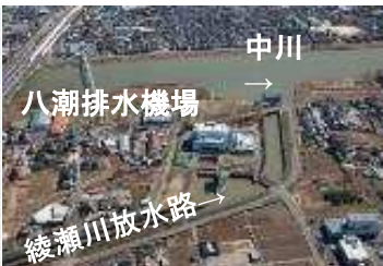
（河川対策）放水路、排水機場の整備による内水排除
