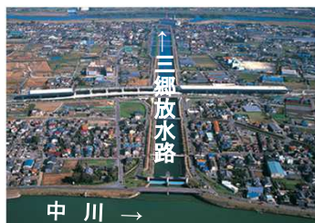
（河川対策）放水路、排水機場の整備による内水排除
