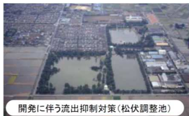
雨水流出抑制対策の例
