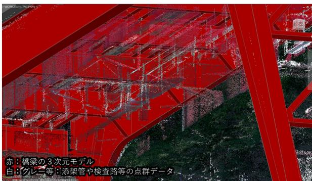
図-3 点群データと3Dモデルの重ね合わせ
