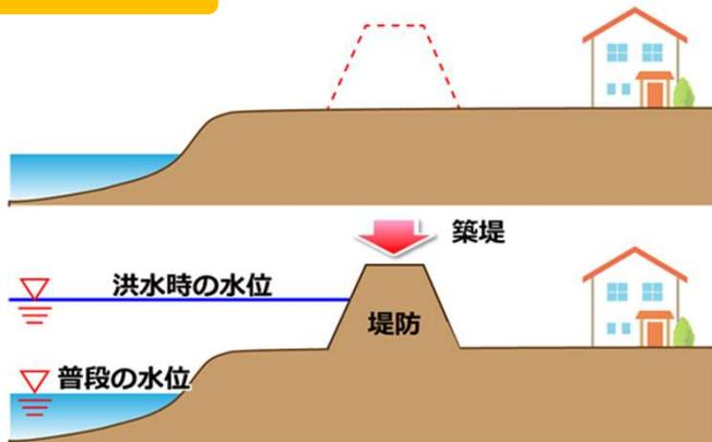
洪水を氾濫させないために、築造した盛土（土を盛り固めた）のことを「堤防」といいます。
