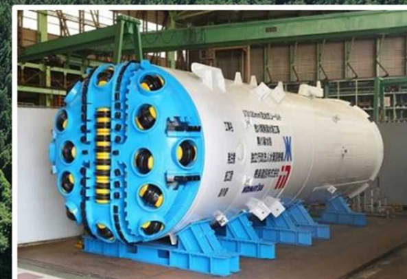
黒川導水路シールドマシン
