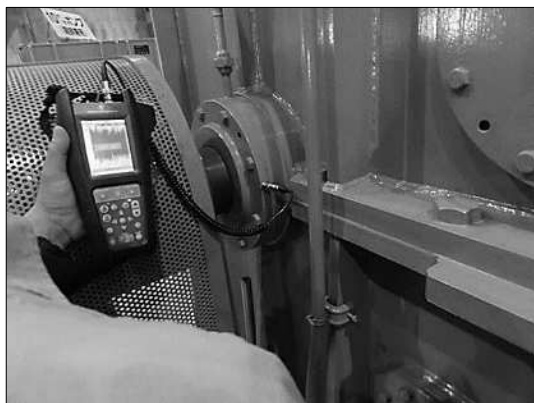
写真1 加速度計による測定方法例
