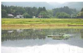
①自動抑草ロボット 泥を巻き上げて、草の発生を抑制するロボット
