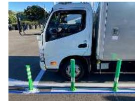
▲設置間隔と高さの違い（高さ65cm/80cm、1m間隔）（実験7）
