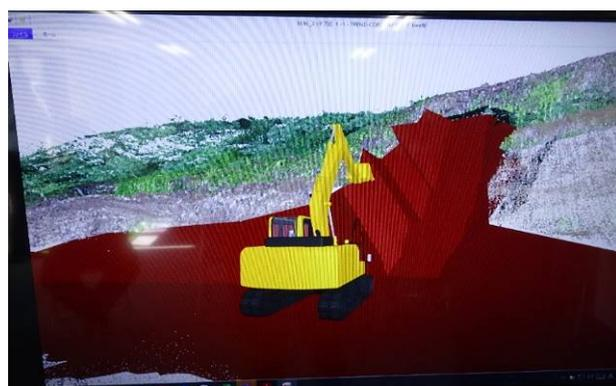
図-9 掘削中の施工ステップモデル
