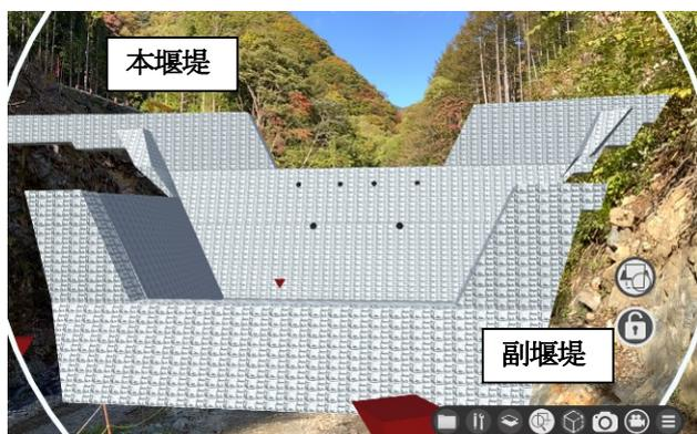
図-7 ARで写した完成モデル
