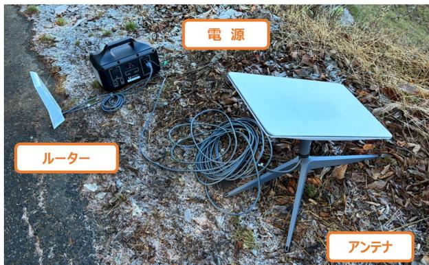
写真-6 Starlinkアンテナと設置状況
