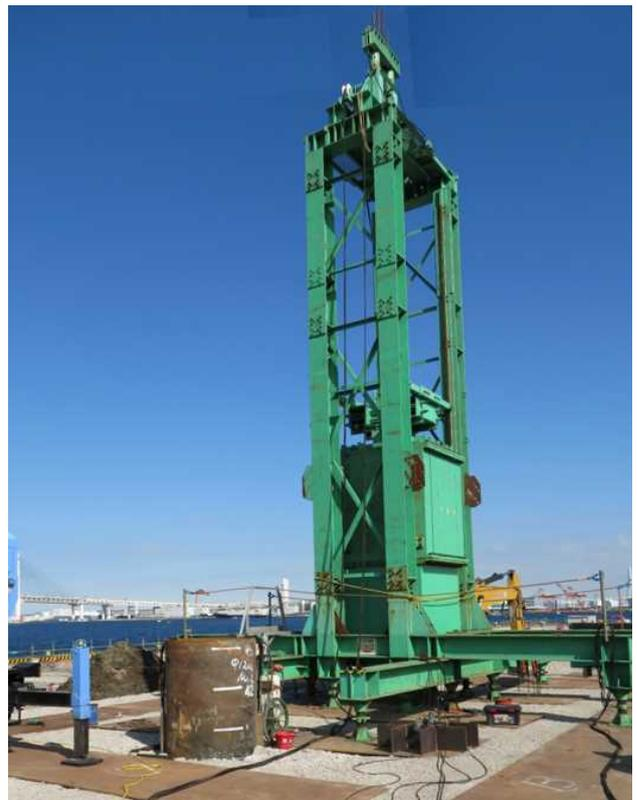
写真-3 68t重錘落下装置
