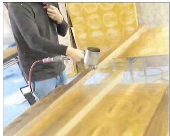
写真4. 液体ガラスの塗装作業
