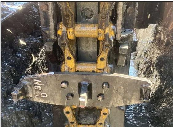
写真-2 TRDカッターポストに設置するカッタービット
