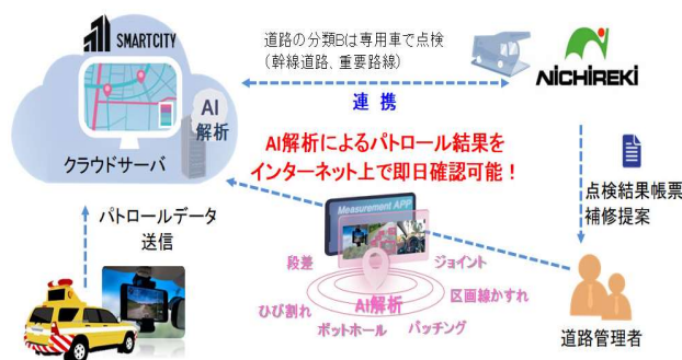
図1 道路損傷検出システム概要図
