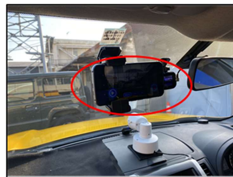
写真 2 パトロール車にスマートフォンを設置 (内観)
