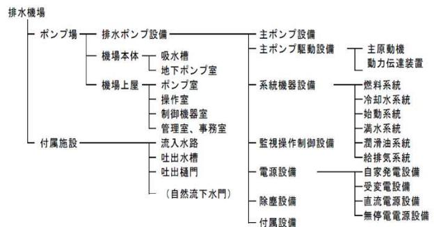
図-2 一般的な排水機場の機器系統<sup>1)</sup>
