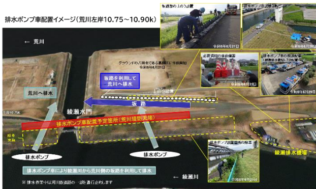
図ー8 排水ポンプ車配置イメージ
