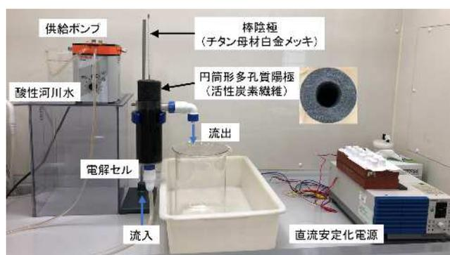
図1 通電実験に用いた中和処理装置
