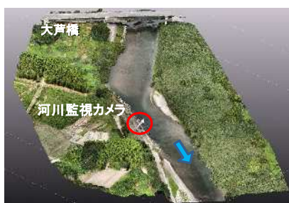
図-3 写真測量による地形の作成
