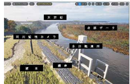
図-8 河川仮想空間モデルの構築
