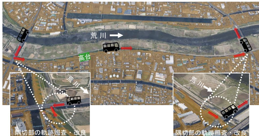
高台から浸水区域外への避難経路を確保するため橋梁と堤防天端が接道する隅切部はバス等の大型車両の通行が可能か軌跡照査を行い、必要に応じて改良を実施
