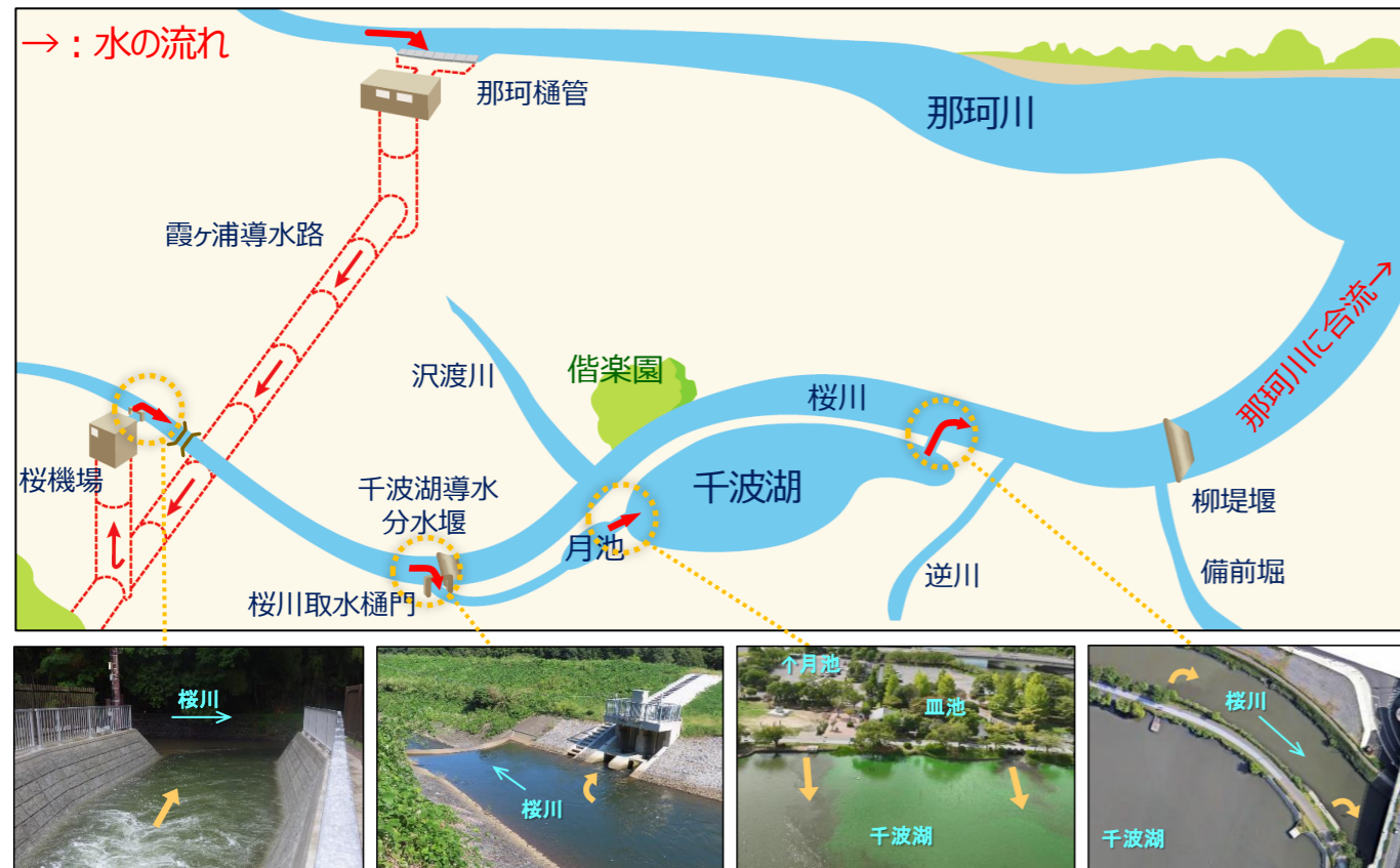
那珂樋管から取水した那珂川河川水を、桜機場で桜川に放流します。 その水を桜川取水堰から取水し、月池を経由して千波湖に流れ込みます。
