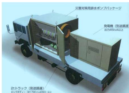
可搬式ポンプの配備・拡充(排水ポンプパッケージ)
