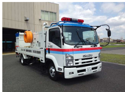
排水ポンプ車
