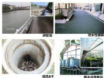
雨水貯留浸透施設の例
