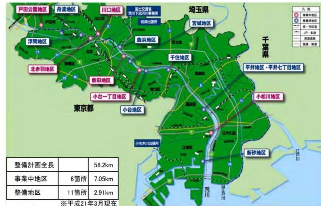
図 3-2 荒川下流部におけるスーパー堤防整備状況
