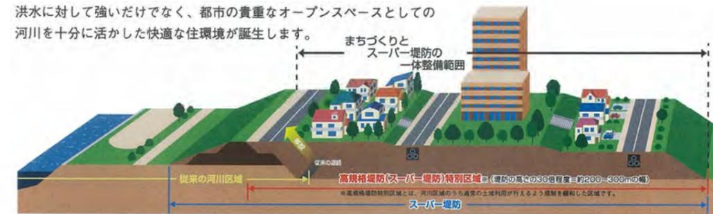
図 3-3 スーパー堤防整備の概念図
