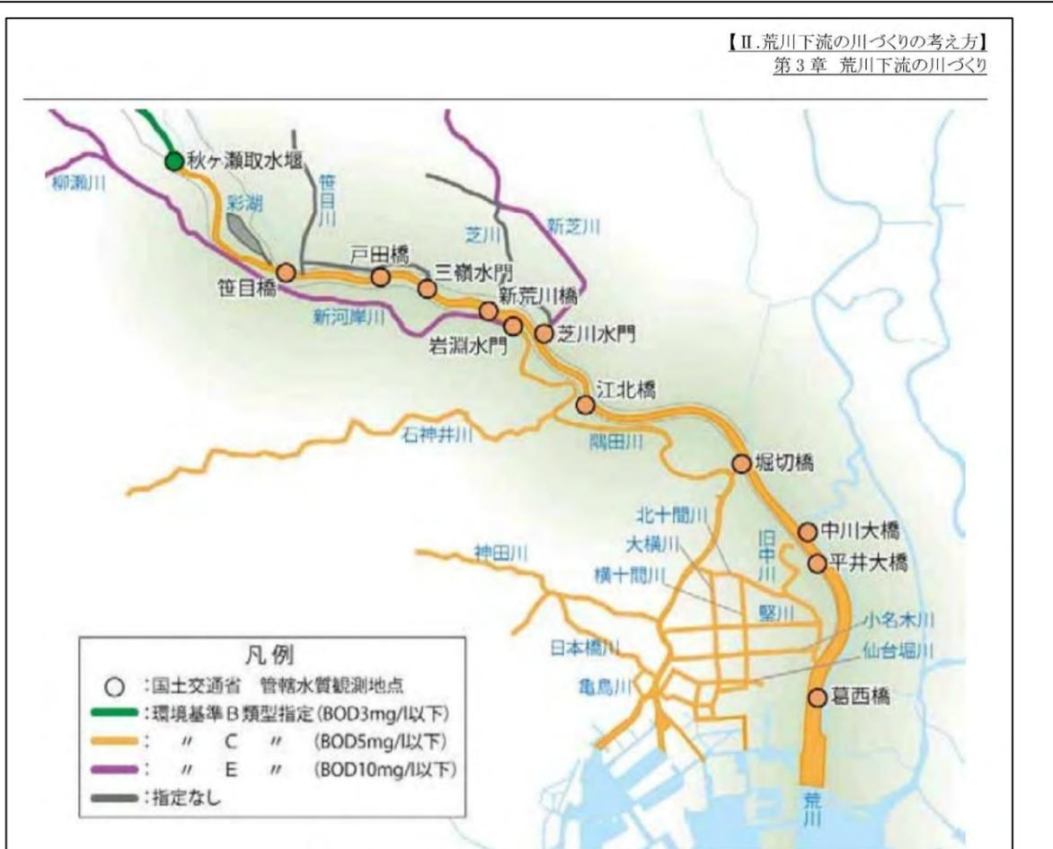
図 3-37 荒川下流部の水質観測地点と類型指定状況
