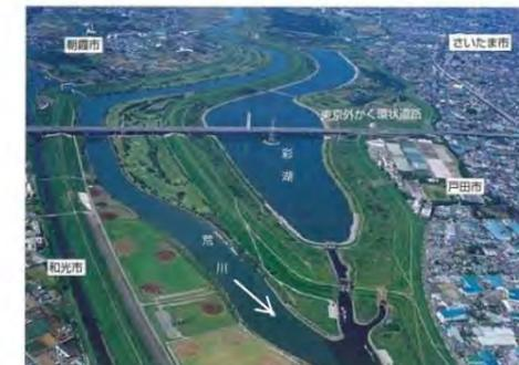
図 2-3 荒川中流部の荒川第一調節池(彩湖)
