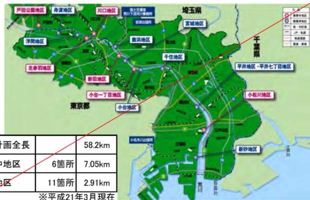
図 3-2 荒川下流部における高規格堤防整備状況
