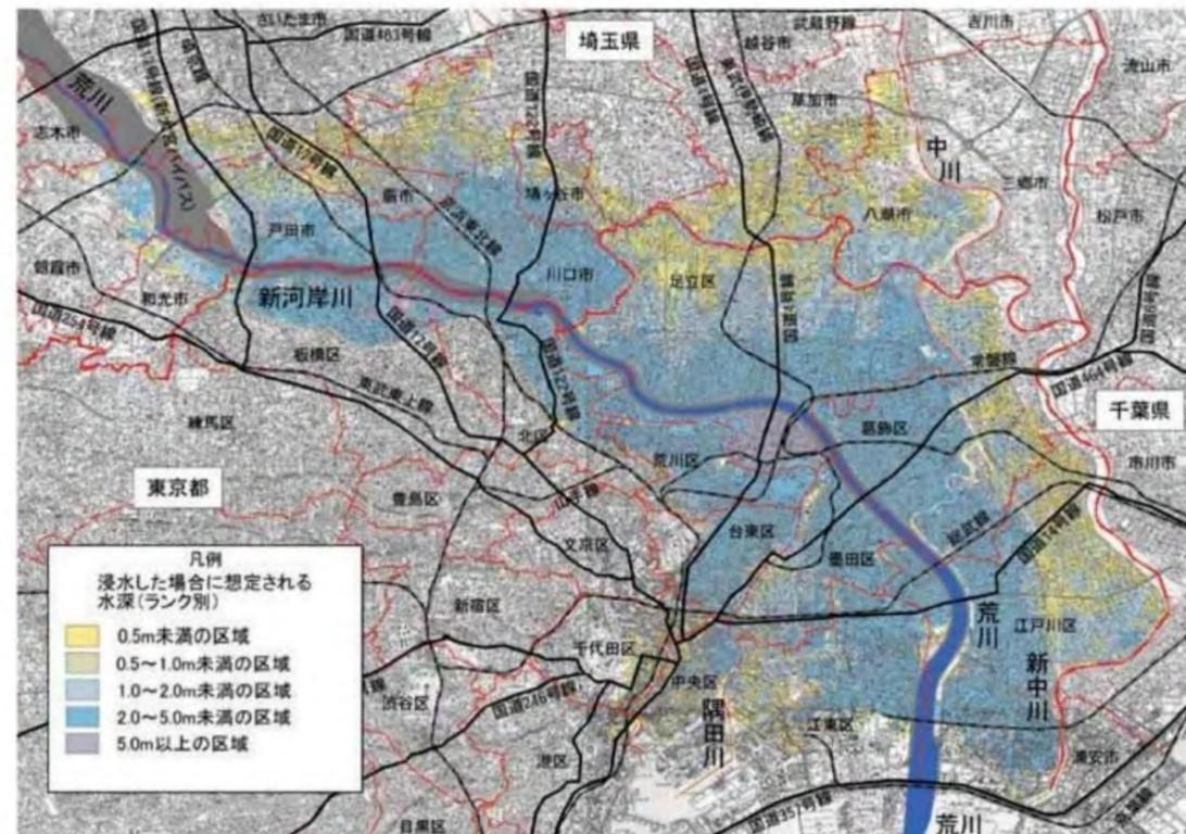
図3-9 荒川浸水想定区域図（荒川下流部版）
