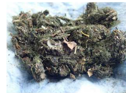
二次オートストレーナ詰まった塵芥 (一部)
