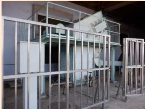
①ネット式除塵機 目幅: 10mm
