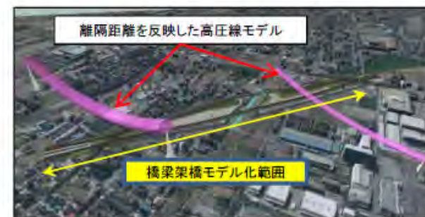
橋梁と架空線の離隔確認
