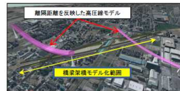
橋梁と架空線の離隔確認
