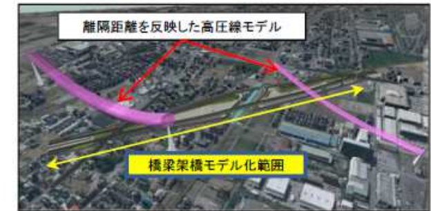
橋梁と架空線の離隔確認
