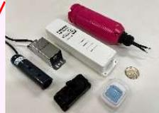
実証実験に用いている6種類の浸水センサ
