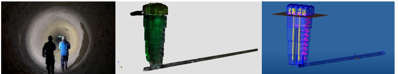
図-3 UAV による導水路トンネル撮影の様子(左図)、その撮影結果から生成された点群(中図)、そして点群から生成された3次元モデル(右図)
