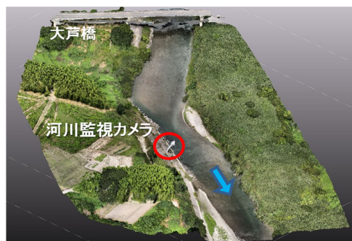
図-3 航空写真測量による地形データの作成
