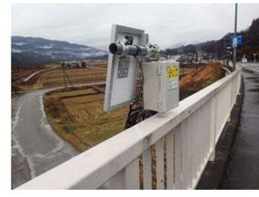
図5 送信機の太陽電池パネル設置状況
