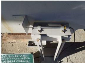
図6 起点側の防水型変位計
