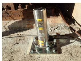
図7 据置型傾斜計
