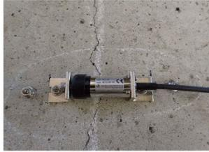
図3 亀裂変位計
