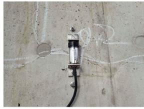
図4 亀裂変位計
