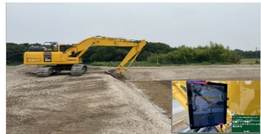
バックホウ(MG)による法面整形
