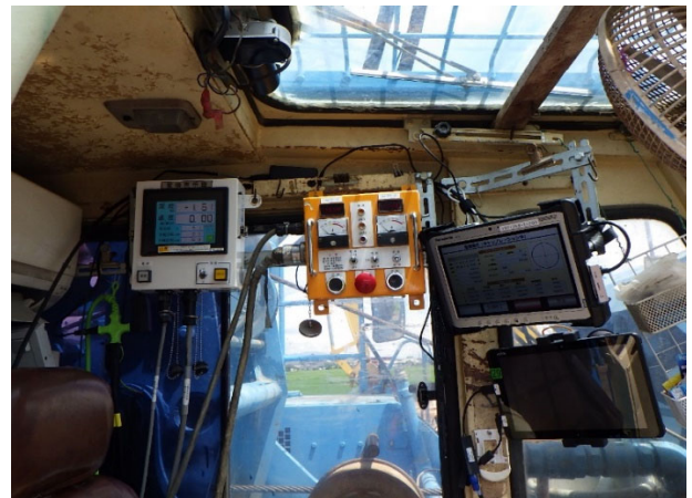
操縦席内での改良深度・座標確認状況
